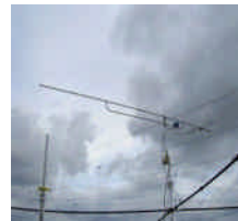
Langyagi-Antenne für das 2-m-Band (aus Wikipedia)
