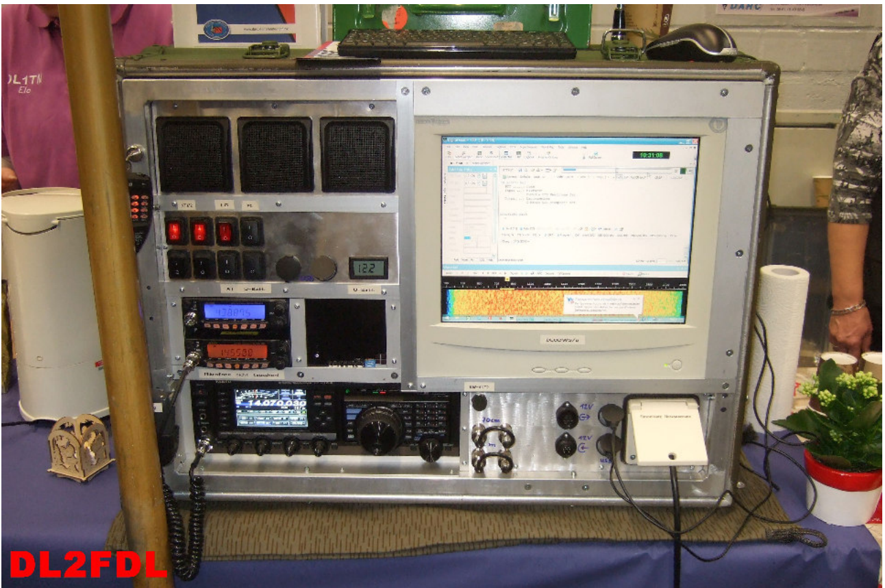
Eigenbau Notfunkstation mit Kurzwellen und UKW-Geräten sowie Computer
