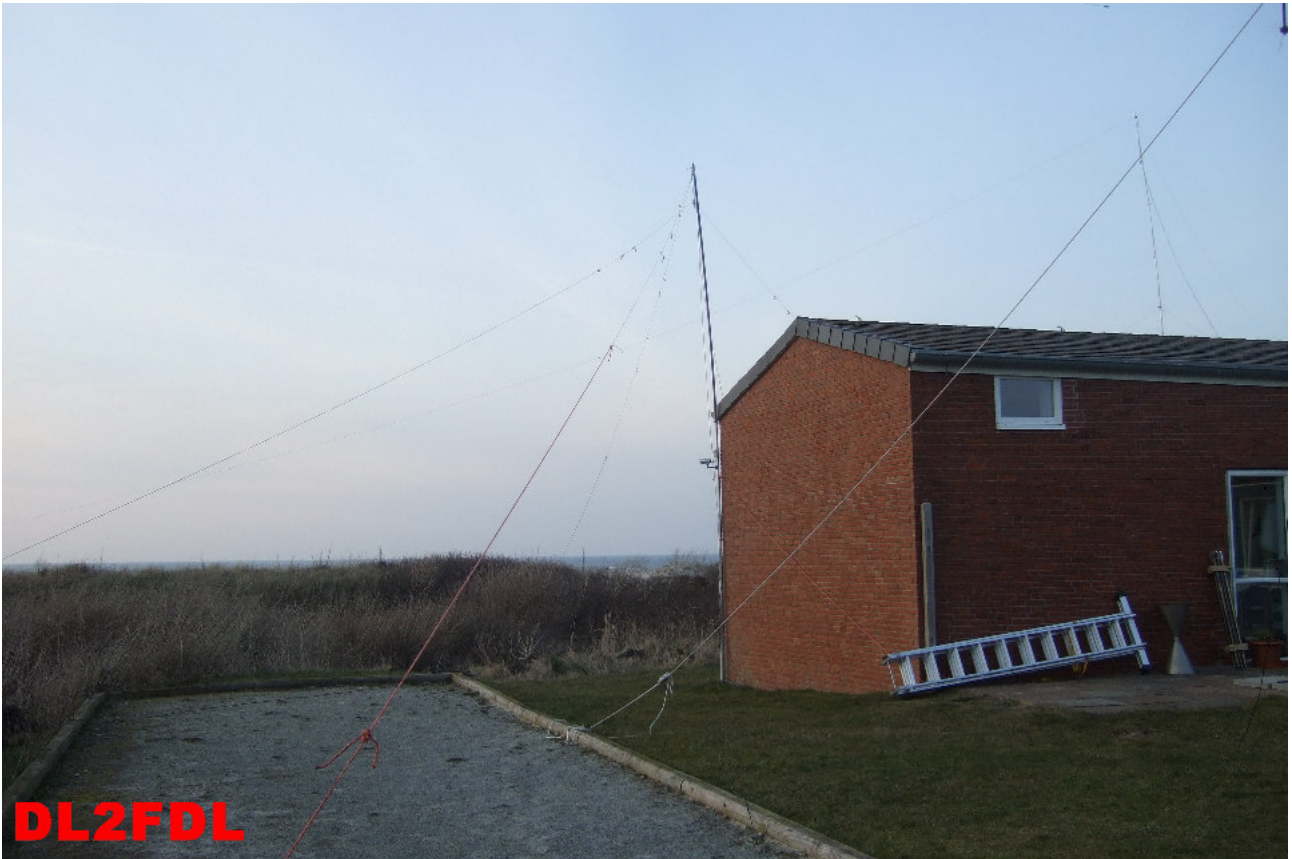
Keleman Dipole für die Bänder 80, 40, 30, 17, 12 und 20, 15, 10 Meter
