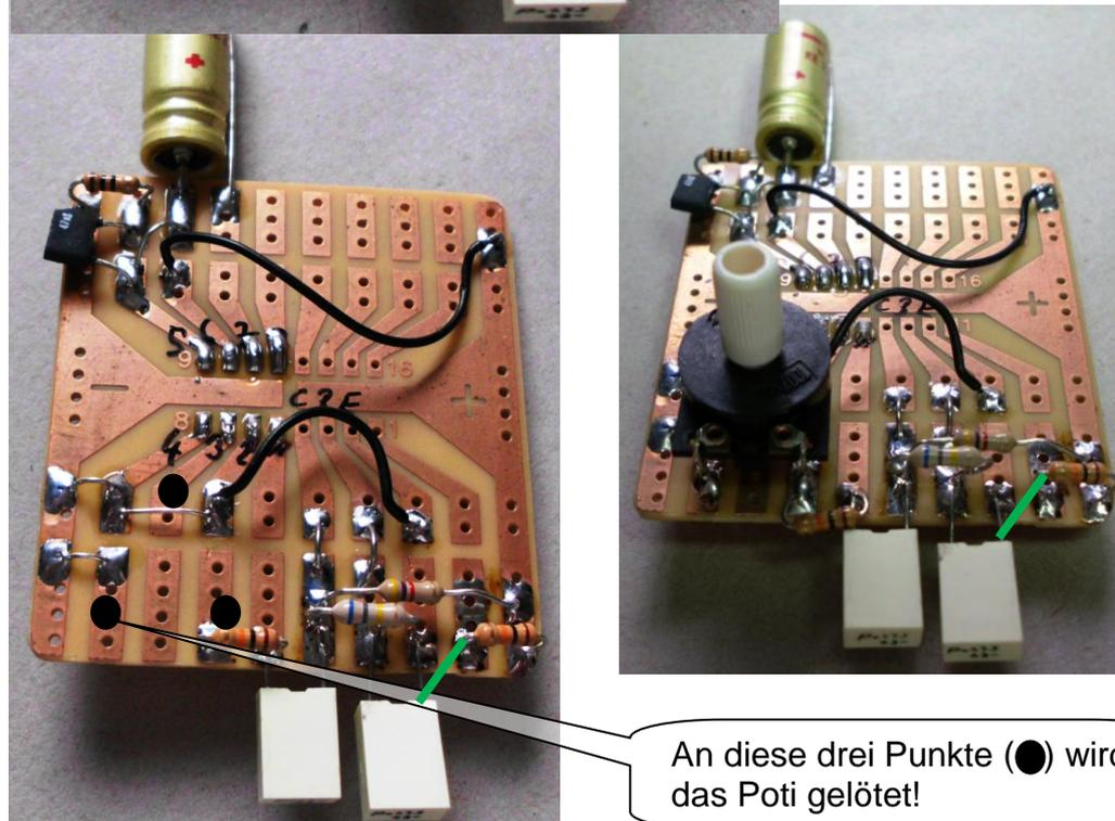
Schritt 5: Anschlussdrähte und Transistor einlöten
