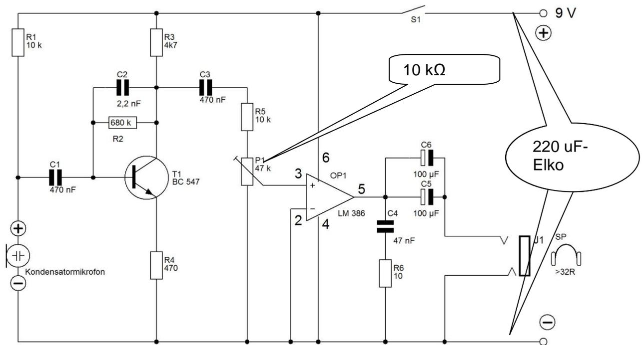
Der Kondensator C2=2,2 nF ist optional / Wichtig: 220 uF-Elko parallel zur Versorgungsspannung verringert Neigung zur Eigenschwingung!.
