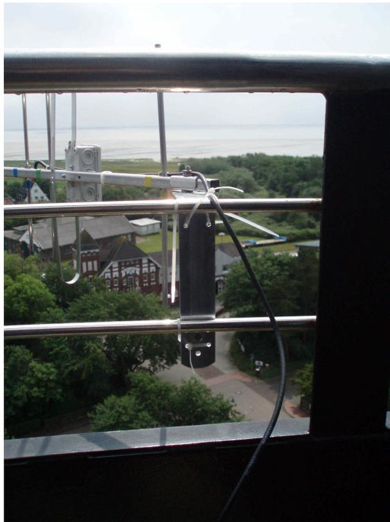
Abbildung 3: Befestigung der Antenne am Geländer
