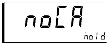
Bild 4-20 Für den aufgesteckten Sondentyp liegen keine Kalibrierdaten vor.
