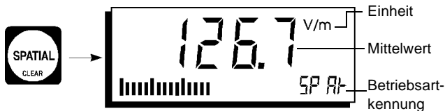
Bild 4-31 Betriebsart "Spatial Averaging" zur Bestimmung der mittleren Feldstärke innerhalb eines räumlich ausgedehnten Gebiets
