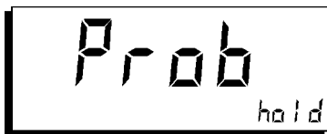
Bild 4-3 Meldung nach Abziehen der Sonde
