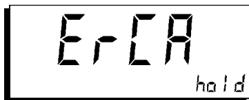
Bild 4-21 Der gespeicherte Datensatz für den aufgesteckten Sondentyp weist einen Prüfsummenfehler auf und kann nicht verwendet werden.
