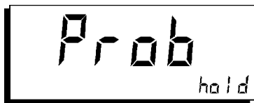
Bild 4-19 Beim Test wurde erkannt, daß keine Sonde aufgesteckt ist.
