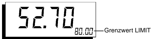
Bild 4-8 Anzeige am Beispiel der E-Feldsonde, frequenzgangbewertet. Prozentuale Leistungsflußdichte gegenüber dem Grenzwert des jeweiligen Standards.
