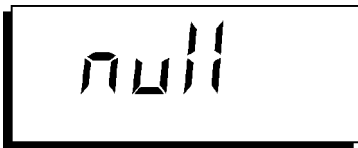
Bild 4-17 Anzeige während des automatischen Nullabgleichs
