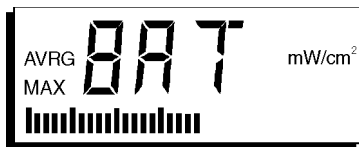
Bild 3-2 Entladeanzeige: BAT wechselt mit dem Meßergebnis
