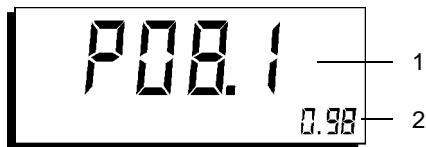
Bild 3-6 Meldung des EMR-200/-300 nach Aufstecken der Sonde 1 Sondentyp und Ausgabe 2 Relative Empfindlichkeit, gerundet auf zwei Stellen
