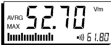
Bild 4-5 Das Gerät ist meßbereit, wenn der Meßwert zusammen mit anderen Anzeigen sichtbar ist
