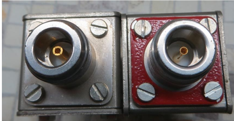
N-Buchsen li 50 \Omega , re 75 \Omega
