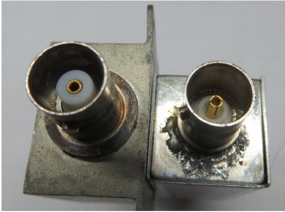
BNC Buchsen li 50 Ω, re 75 Ω
