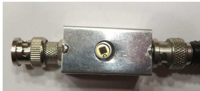
Fotodiode im Gehäuse mit BNC-Anschluss
