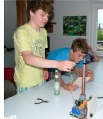
Als nächstes bauen wir einen Sender. Einfacher Oszillator mit einem 48-MHz-Quarz. Wir testen die Reichweite ohne Antenne und danach mit unserer selbstgebauten Antenne. Zum Funken benötigen wir QSL-Karten. Wir entwerfen eine eigene Karte, vielleicht mit einem Gruppenfoto?
