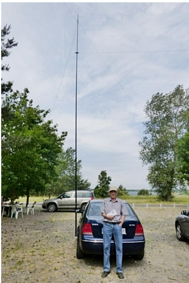
OVV Wilfried vor dem 10 Meter hohen Spidermast mit Windom-Aer. Mit diesem Equipment wurde auf den KW-Bändern gefunkt. Gleichzeitig war eine 2 Meter Linkstrecke aufgebaut, um die Verbindung mit den daheim gebliebenen OM's zu halten.
