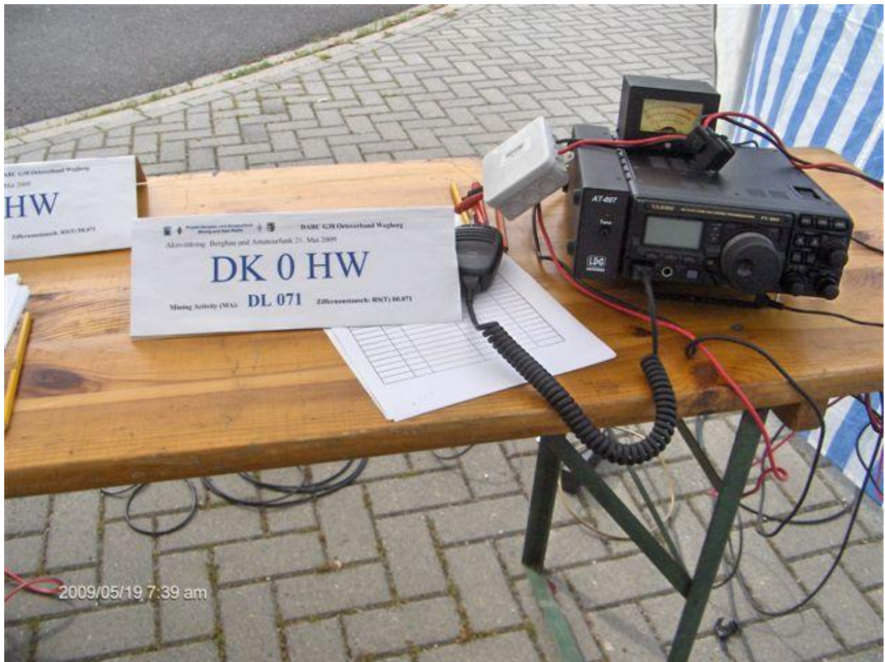
Bild 10: Links am FT-897D der automatische Antennentuner AT-897, der nach Rauchaustritt umgehend außer Betrieb genommen werden musste.
