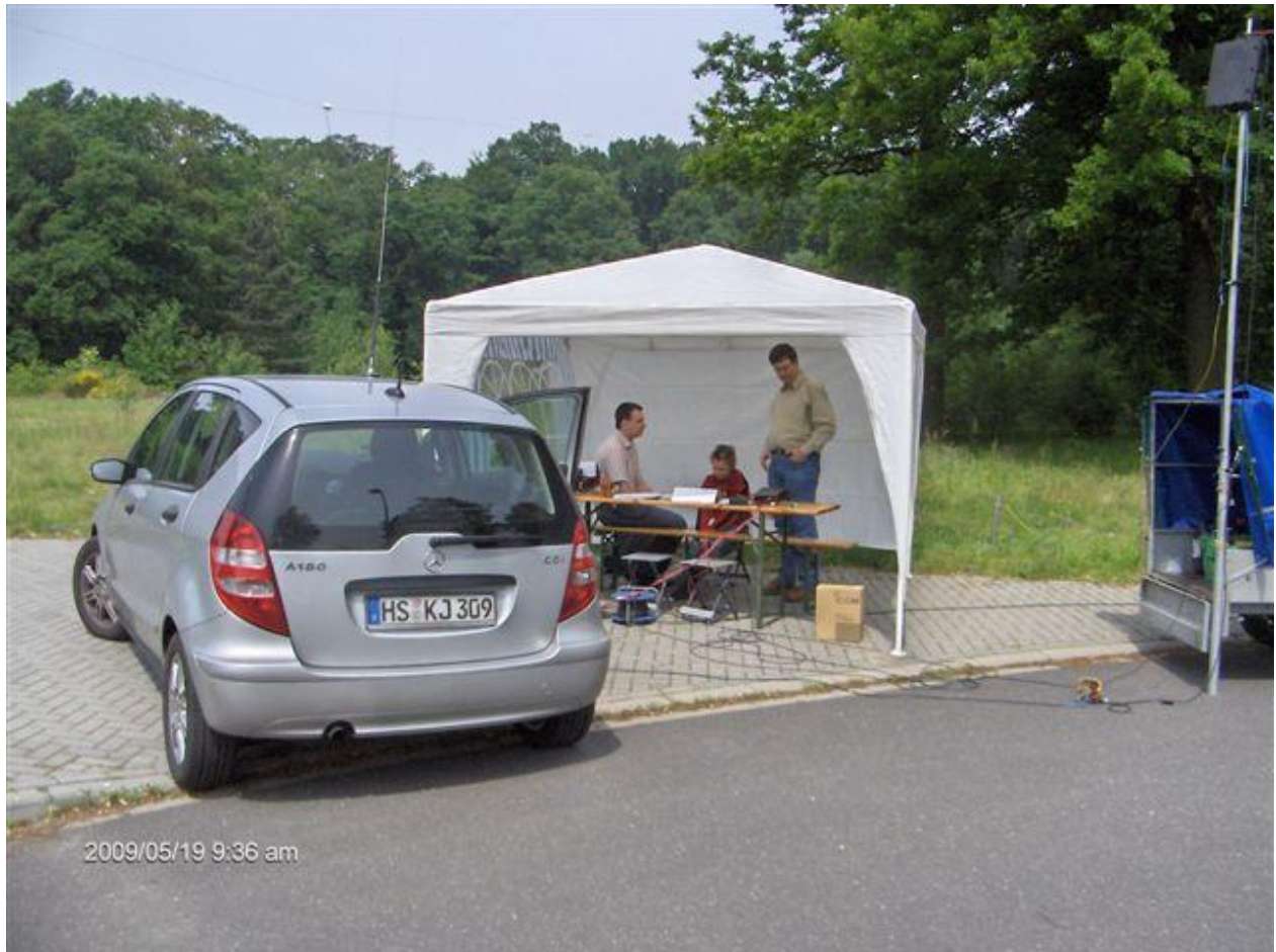
Bild 20: So funktionierte es endlich: Mercedes A-Klasse als Stromquelle und Smarttuner mit Langwellenantenne am Hilfsmast befestigt am Autoanhänger
