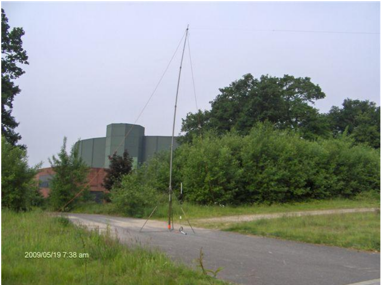
Bild 6: Der Mast mit angehängten Antennen, noch nicht abgespannt, im Hintergrund die ehemalige Kohlenwäsche der Zeche Sophia Jakoba
