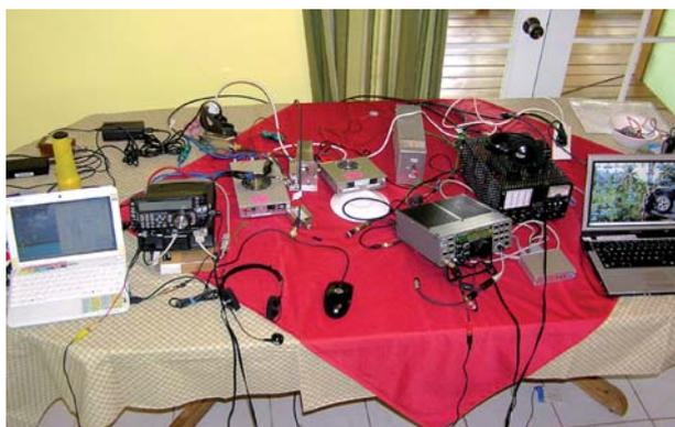
mit dem Elecraft K2 plus PA ist mit 600 W in der Luft. Von beiden Stationen können wir RTTY und PSK machen. Als Interface benutzen wir zwei „Interface ONE“ [1]. Die Interfaces haben eingebaute Soundkarten. Der erste Tag beschert uns von früh bis spät Pile-Ups. So geht es die ganzen ersten Tage. Die guten Funkkonditionen müssen einfach ausgenutzt werden. Zum Einkaufen stehen wir uns am Vormittag für eine Stunde von den Funkgeräten weg.
