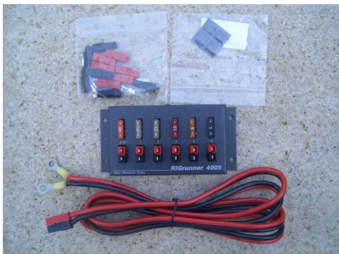
Bild 16 Verteiler mit 5 Ausgängen
