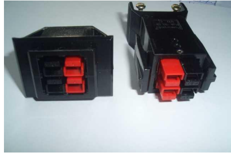
Bild 14 Halterung + Stecker für 4-pol. Kontaktblock von vorn
