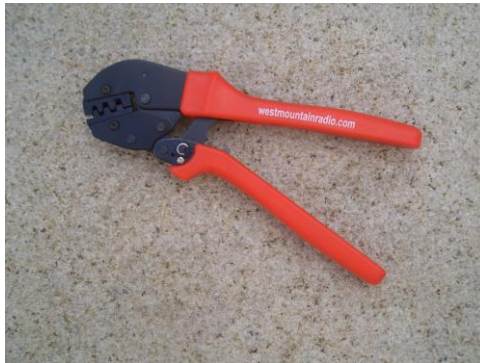
Bild 2 +3 Krimpzange für 3 Kontaktgrößen 15A, 30A, 45 A
