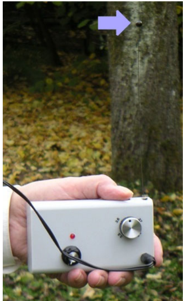
Der Pfeil zeigt auf die Kugel am Ende der ausziehbaren Hilfsantenne
