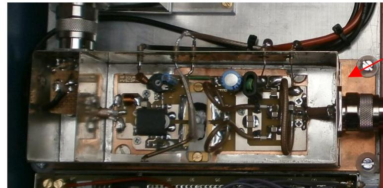
Endstufentransistor auf der Kupferschiene bzw. Kühlkörper
