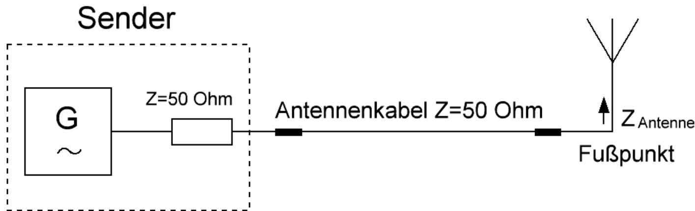
$$SWR = \frac{Z_{Antenne}}{Z} \quad (\text{wenn } Z_{Antenne} > Z)$$
