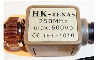
1:10 Tastkopf, B = 250MHz, Spannung max. 600Vp
