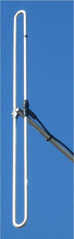
Im **UKW-Bereich** kommt es zum Einsatz von **Faltdipolen**, weil man die Stelle gegenüber der **Einspeisung** erden kann. Dadurch ergeben sich Vorteile beim **Blitzschutz**.
