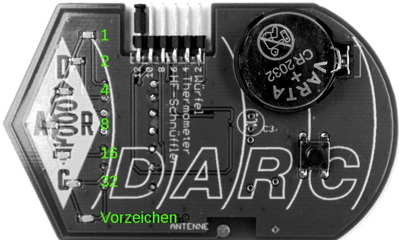
Eigentlich wurde diese spezielle Anzeige eher für Testzwecke eingebaut, man kann sie aber für Temperaturmessungen nutzen, die sich mit dem „normalen“ Thermometer nicht anzeigen lassen: Temperaturen unter 18 Grad oder über 32 Grad.
