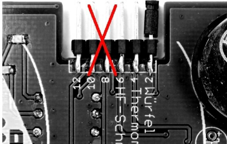
Die Brückenpositionen 8 und 10 werden nur für das Laden des Programms in den Mikrocontroller gebraucht. Die Steckbrücke dort bitte nicht aufstecken. **Im schlimmsten Fall kann unser Platinchen (genauer der Mikrocontroller) dadurch zerstört werden.**
