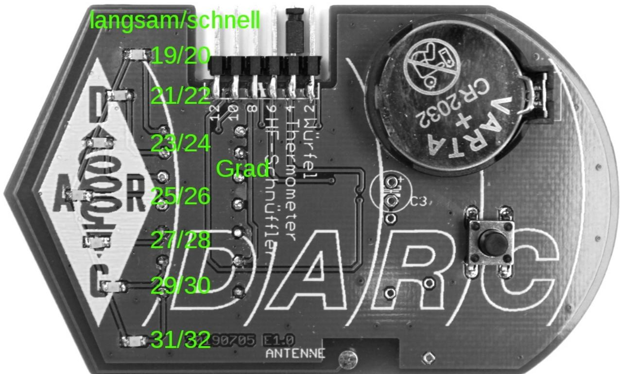
Wird die Steckbrücke auf die mit „Thermometer“ bezeichnete Position 4 gesteckt, gibt der Mikrocontroller seine Temperatur aus.
