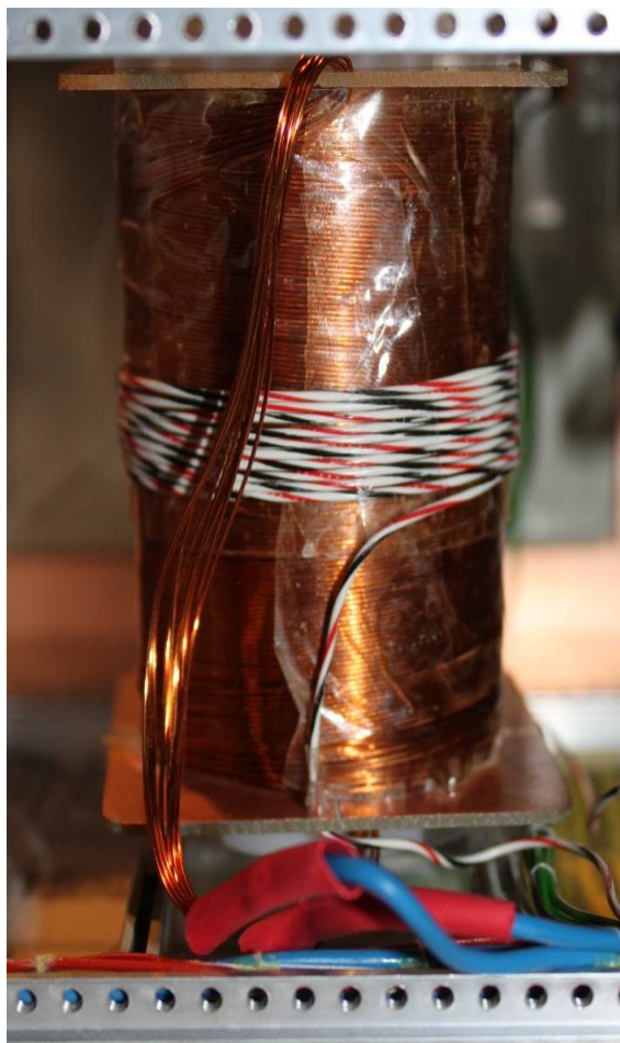
Spule mit 10x0,5mmCuL „flach“ gewickelt.
