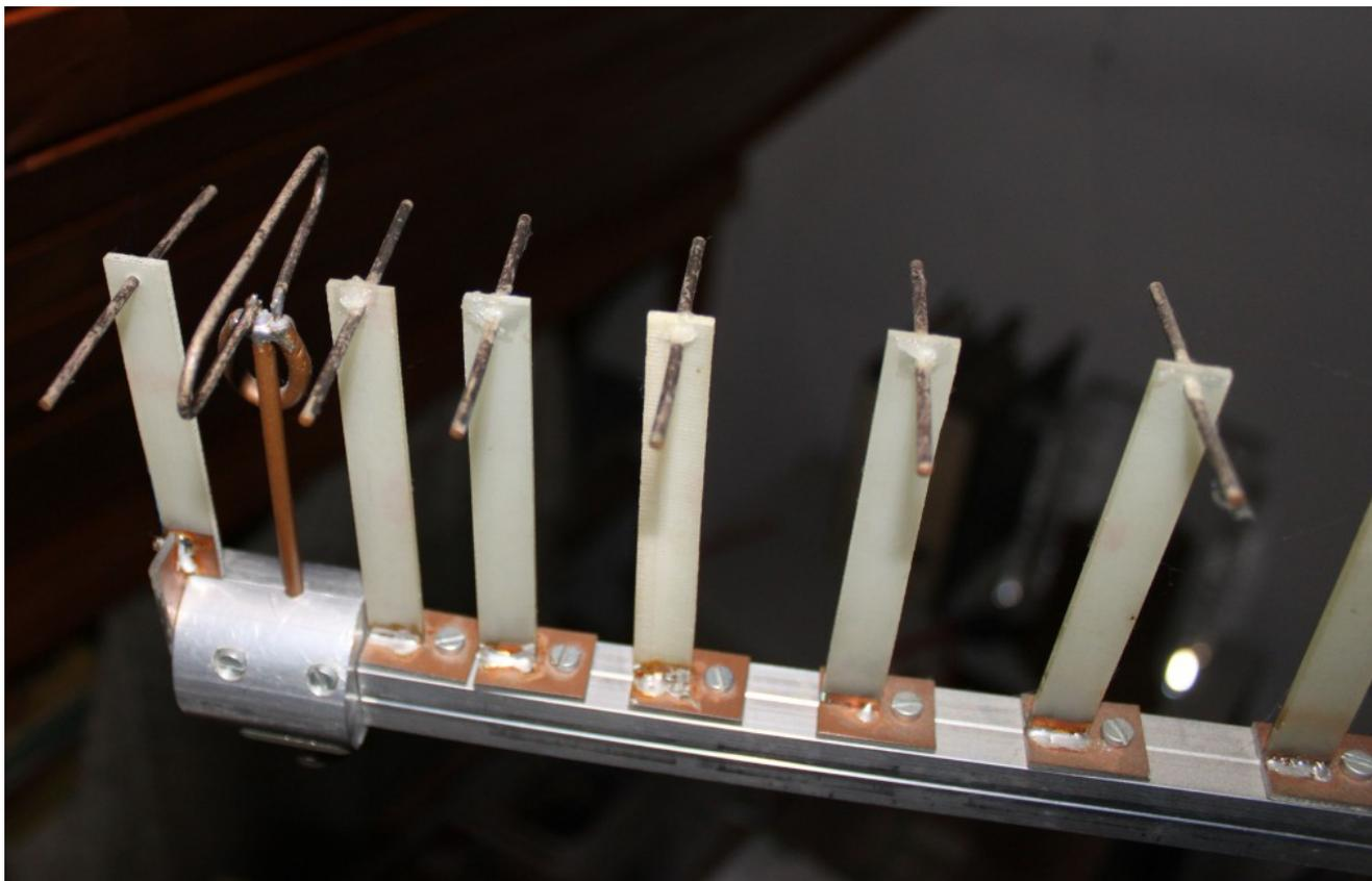
Bild 6: Eine mit Stützern und Schleifendipol aufgebaute Antenne für das 13cm-Band
