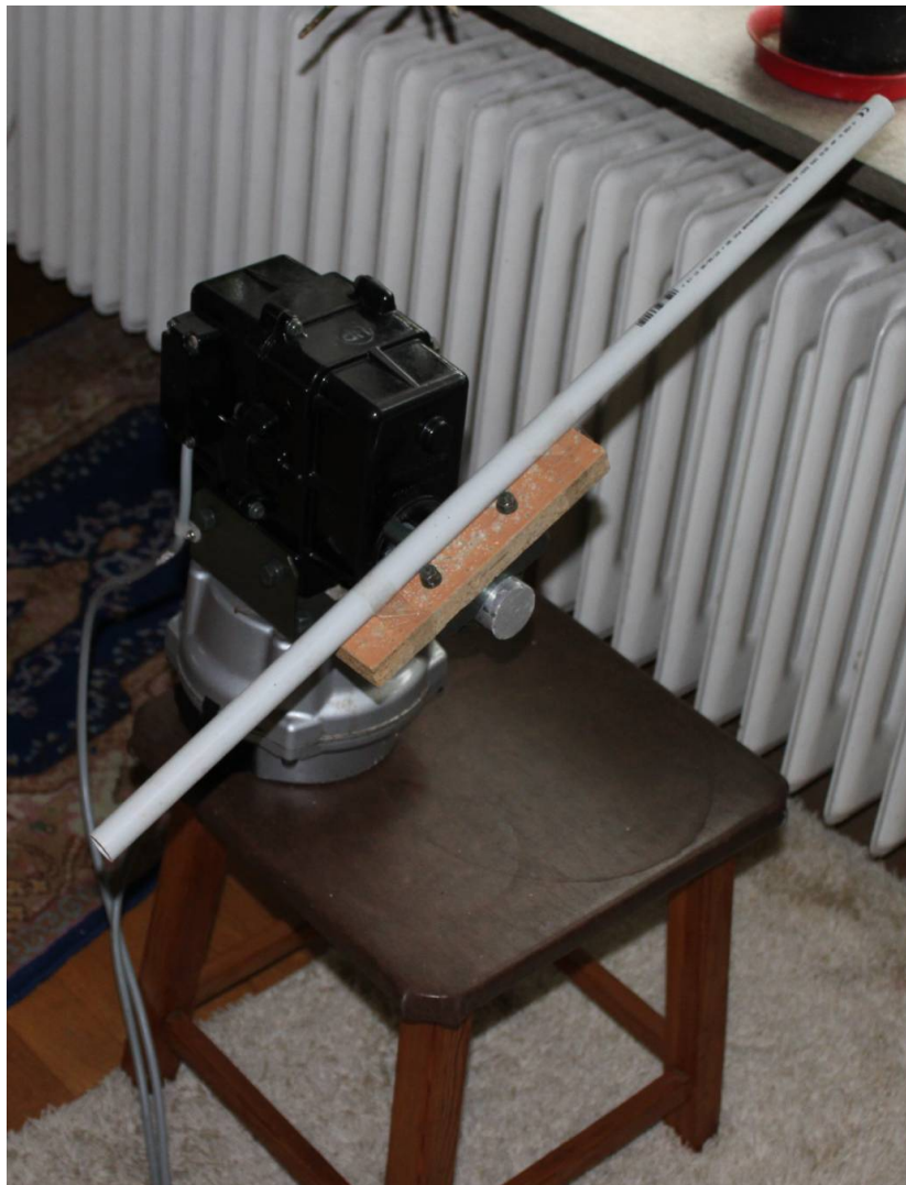
Bild 6: Aufbau für den Test der Positioniergenauigkeit
