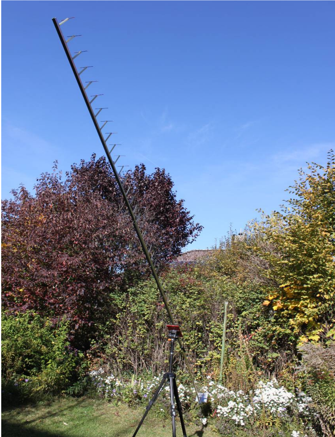
Bild 4: Montage der EME-Antenne auf einem Fotostativ.
