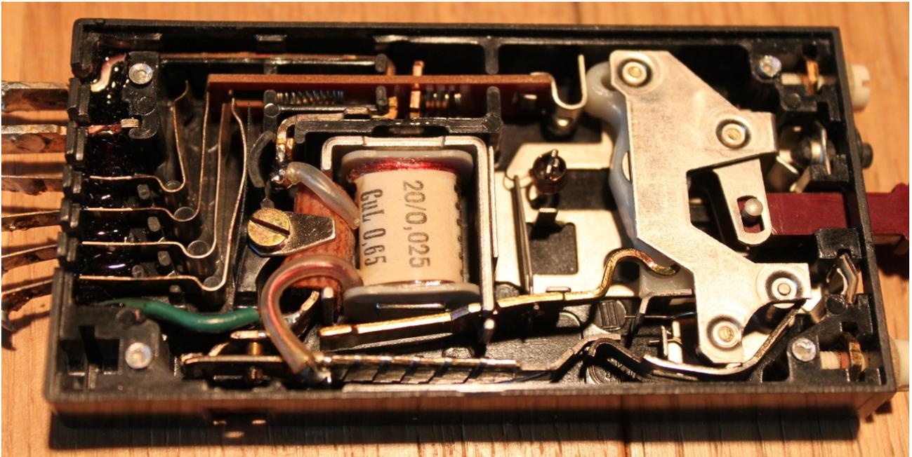
Bild 9: Sicherungsautomat (vor dem Umbau)
