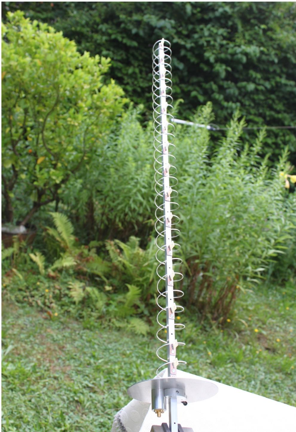
**Bild 1: Helix-Antenne für 2400 MHz**
