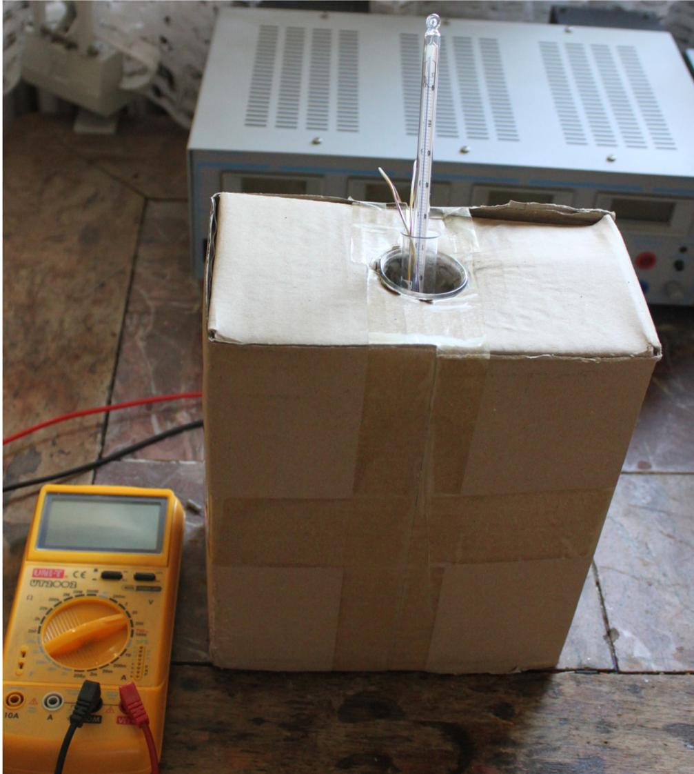
Bild 11: Aufbau zur Messung der NTC-Parameter
