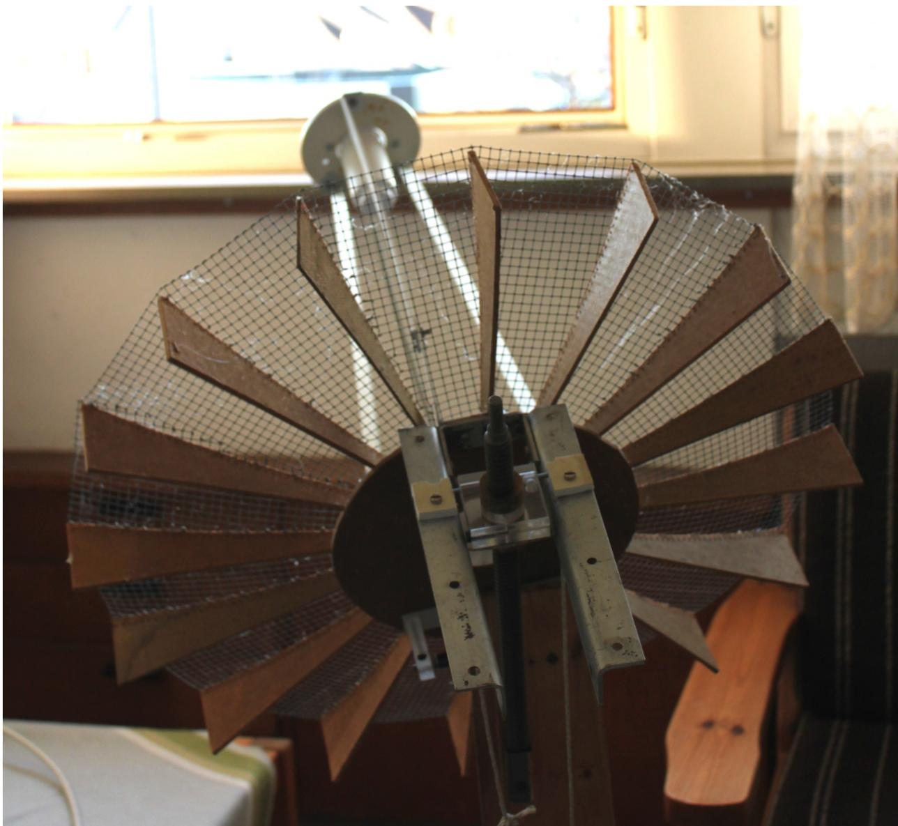
Bild 1: Eigenbauspiegel mit Kuhne LNB
