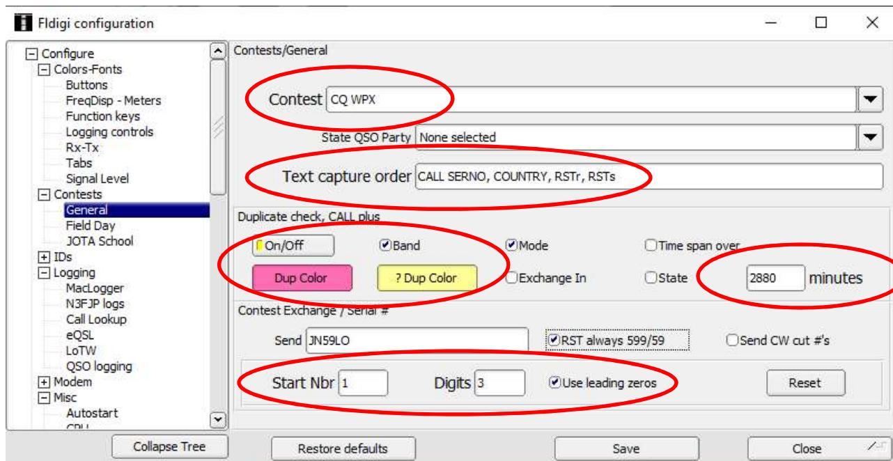
Ermöglicht Duplikate-Anzeige, sowie Text Capturing CALL und SERNO im Empfangs-Feld, einfach durch Mausklick (linke Maustaste)
