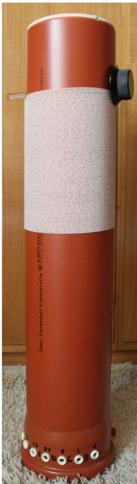
Bild 24: Aussehen und Schaltbild der Anpaßspule
