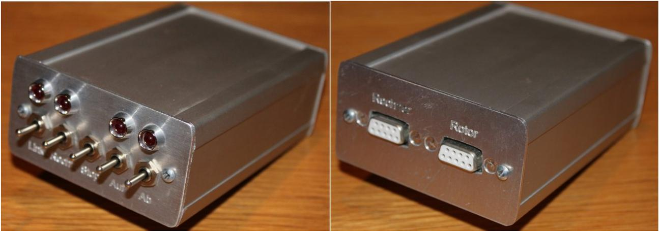
Bild 14: Vorder- und Rückansicht einer für Satelliten- und EME-Betrieb nutzbaren Rotorsteuerung.
