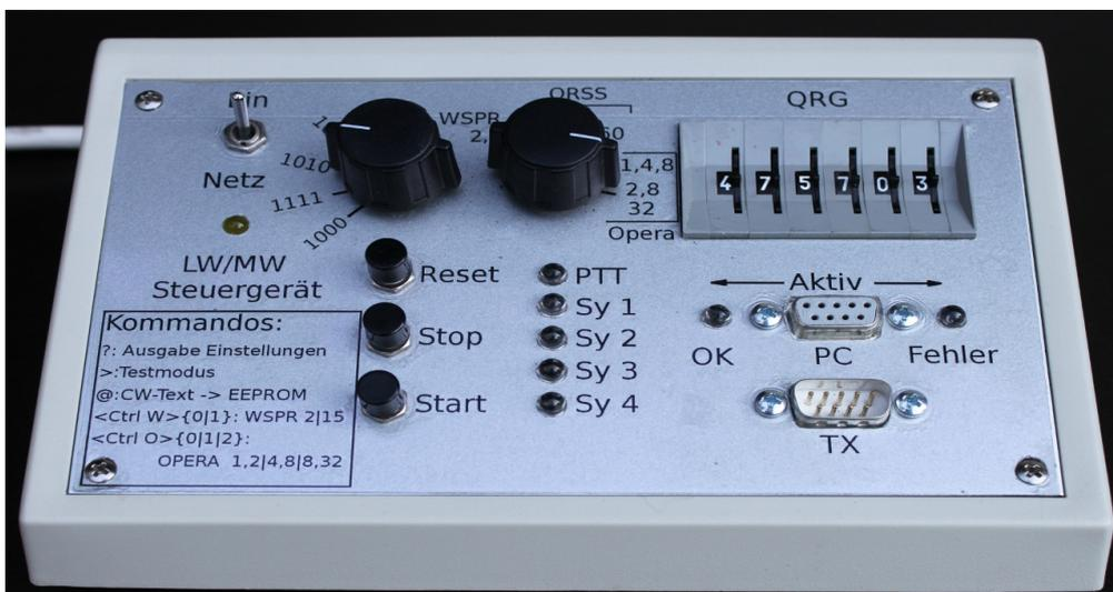
Bild 12: Steuergerät für einen MW- oder Langwellensender für die Betriebsarten WSPR, OPERA und QRSS.
