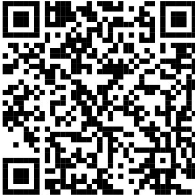
Bild 8: Nicht „maskiertes“ Ergebnis direkt nach dem Eintrag von Nutzdaten in das Version 5 Quadrat.
