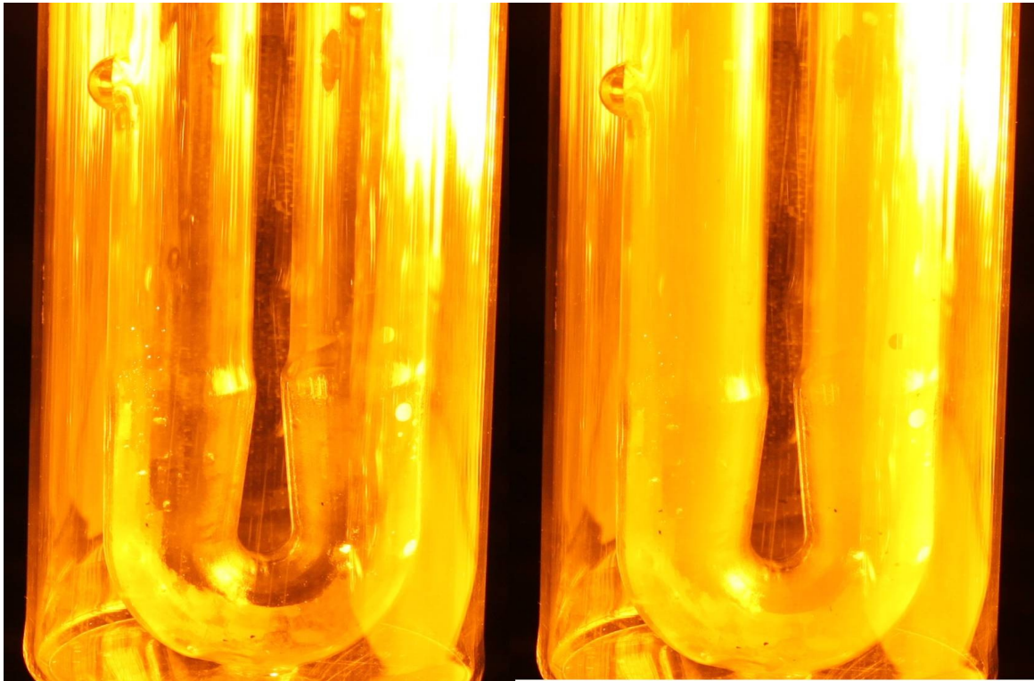
Bild 3: Ein mit Licht einer Natriumdampfampe bestrahltes Glasrohr links ohne Natriumdampf, recht mit Natriumdampf. Im rechten Teil ist deutlich der durch die Lichtstreuung hervorgerufene Nebelfeffekt zu sehen.
