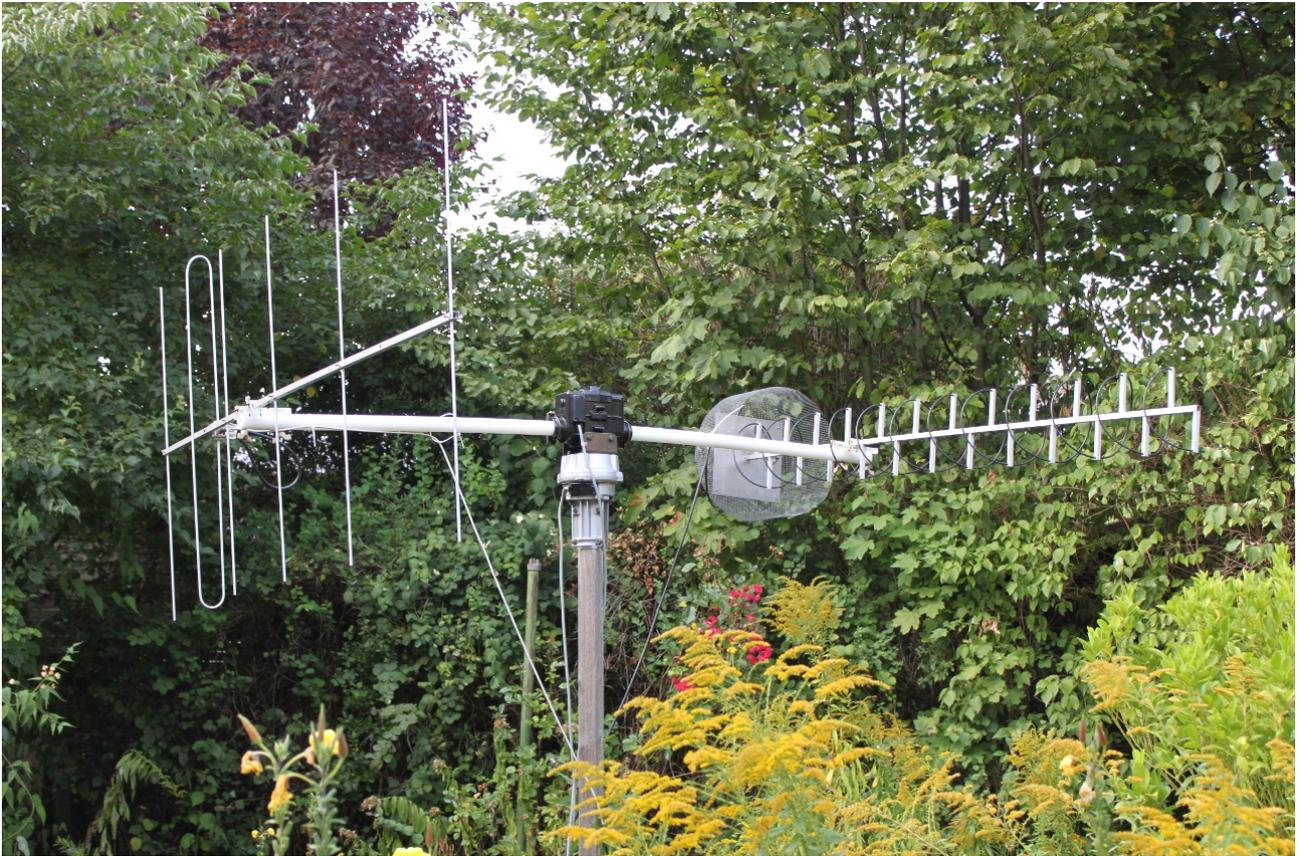
Bild 4: Antennenkombination für Satellitenfunkbetrieb
