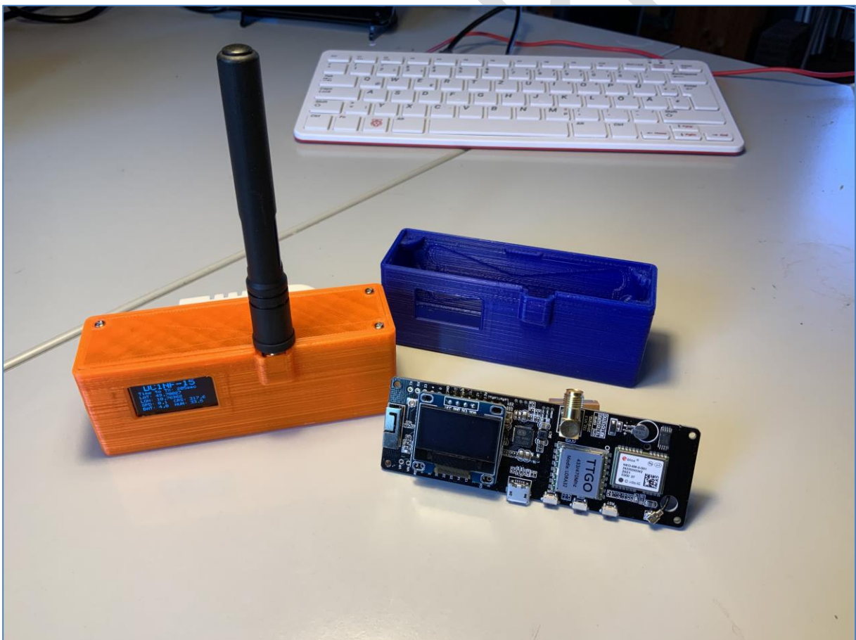
Tracker (Standort und/ oder Wetterstation), gedrucktes Leergehäuse, TTGO-Baugruppe
