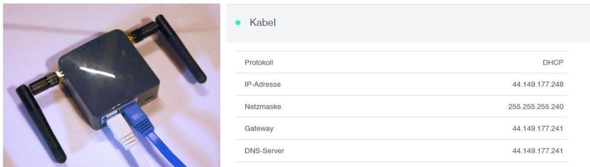
Abbildung 7: Zwischenrouter und WAN IP-Parameter der DHCP Verbindung mit dem HAMNET über NPR70
