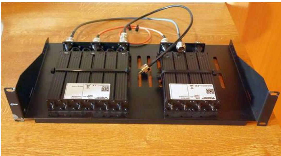
Abbildung 2: Weiche und Bandpassfilter für NPR70 und WINLINK
