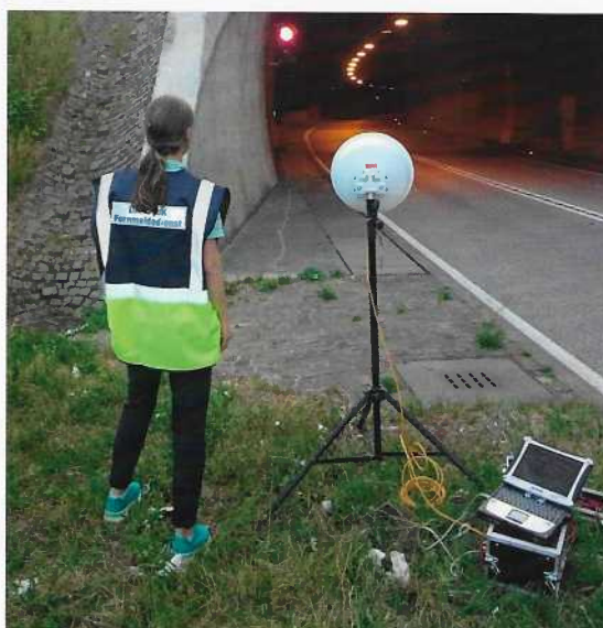
Abb. 3: Mobile AREDN-Node mit Funkamateure vor dem Tunnelportal, versorgt rein aus Akkus
