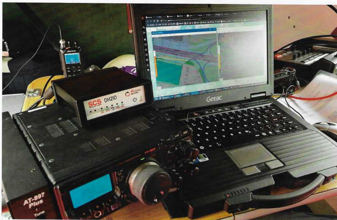
Abb. 1: Station zum Empfang und zur Darstellung von APRS-Positions-meldungen
