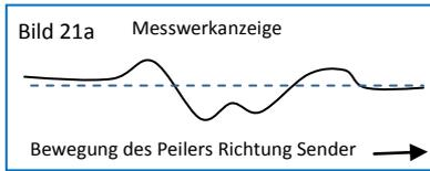
Im Falle eines kleinen Basisabstandes kann der Hub der Maximum-/Seitenpeilung größere oder auch kleinere Werte annehmen als dem Abstand entspricht, und der Nulldurchgang „schieft“ entsprechend dem Phasenfehler.
