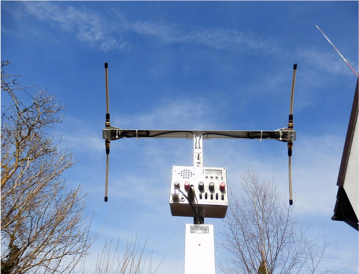
Bild 46c: 2 m-Phasenpeiler mit Gummiwendel-Antennen
