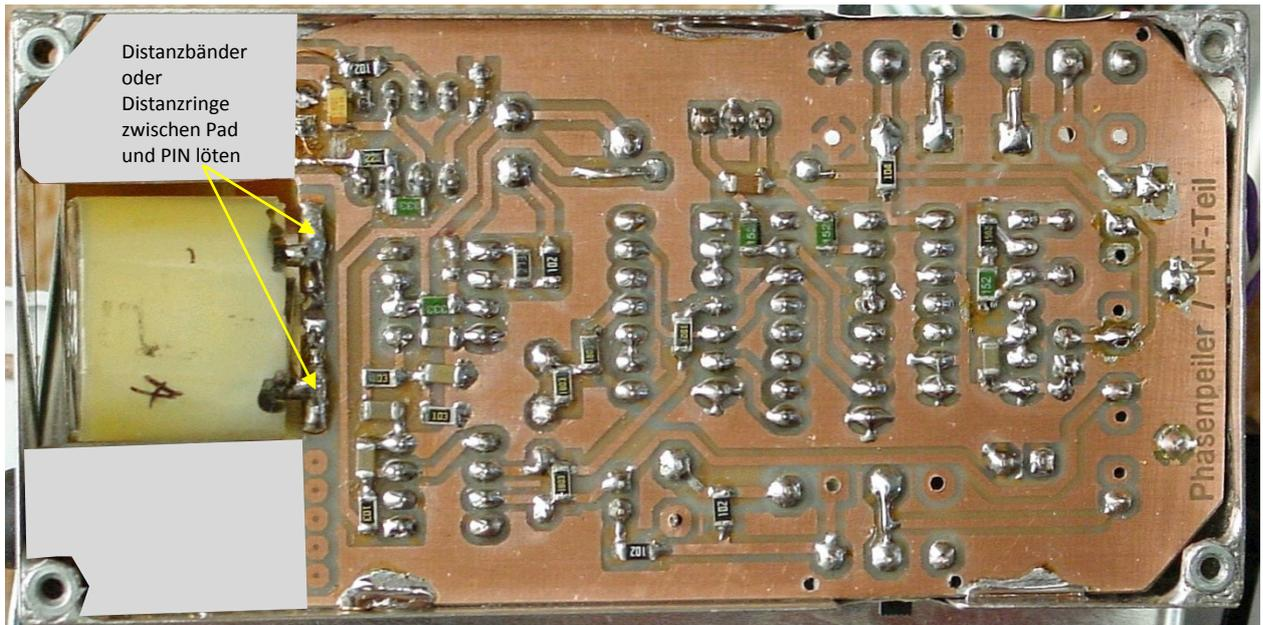
**Bild 41: Einlöten der Platine in das Weißblechgehäuse**
