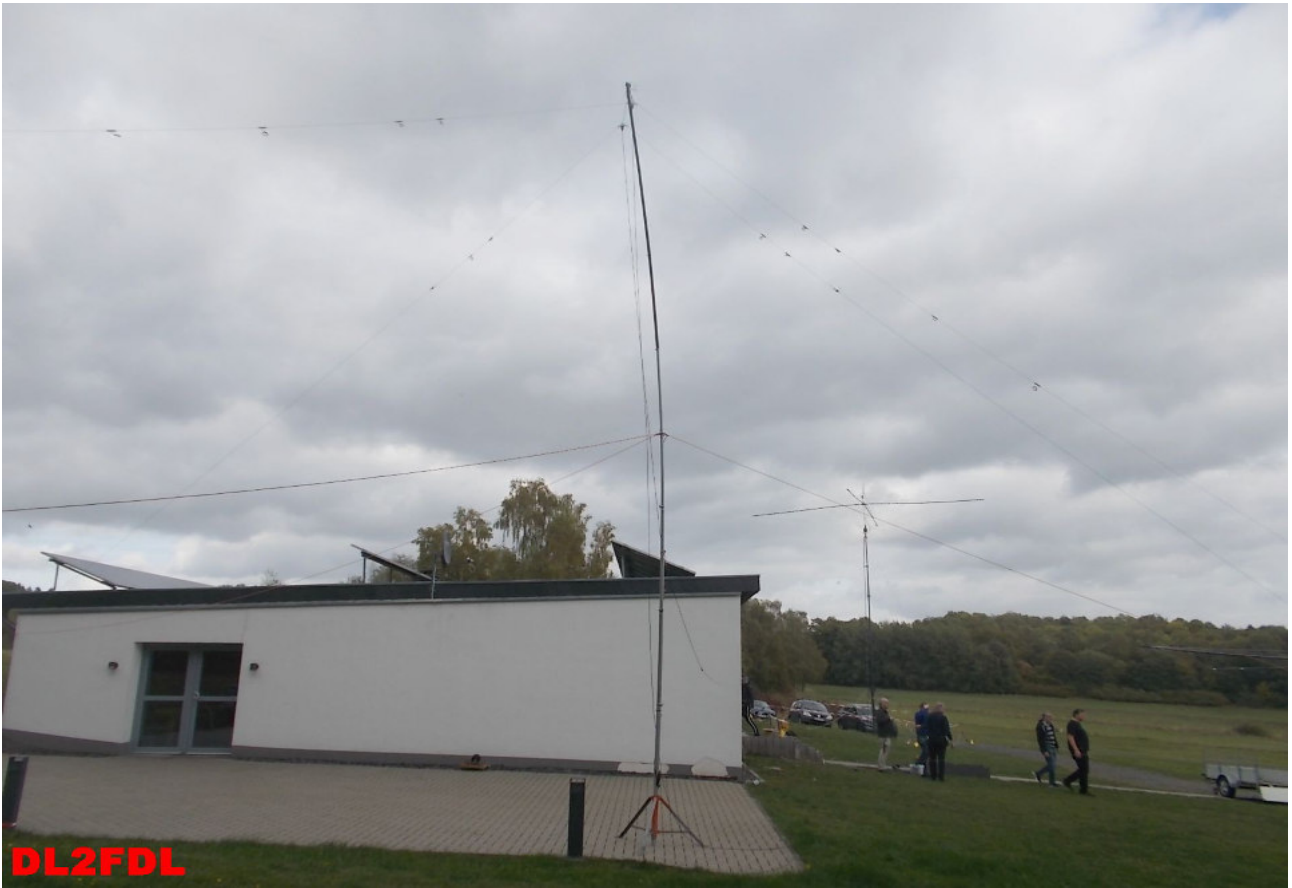
Zwei Keleman Dipole 10/15/20 und 12/17/30/40/80 Meter
