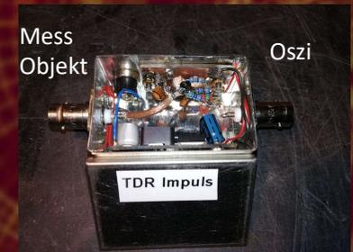
HF gerechter Aufbau fliegend auf eine Kupferplatte ohne Leiterbahnen gelötet
