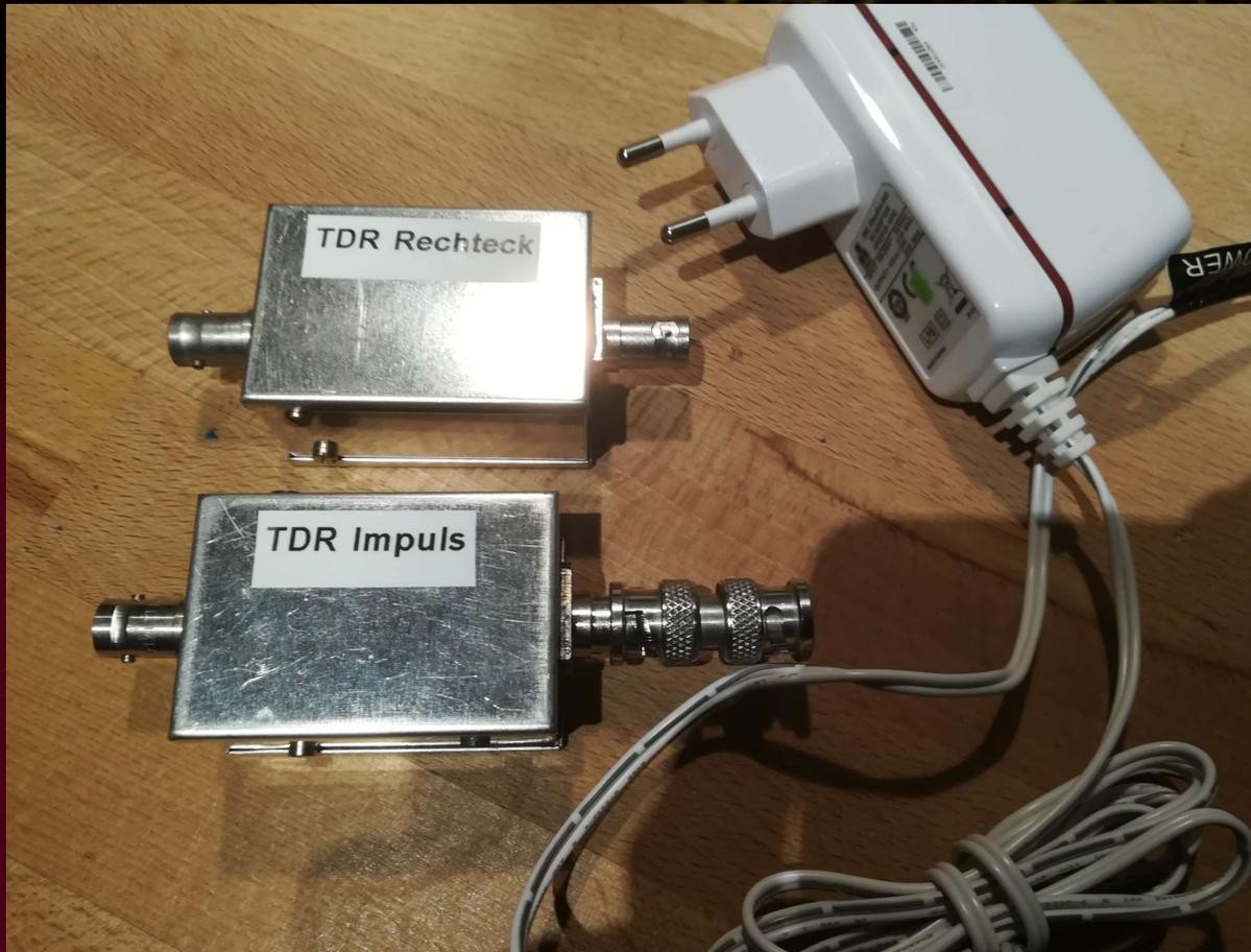
Zum Vorschalten vor das Oszilloskop mit einem 15 V Steckernetzteil.
