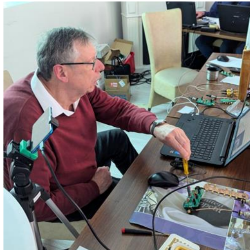
Live-Vorführung und Videoübertragung der Abstimmung an einem Schwingkreis durch Manfred, DH0KAI
