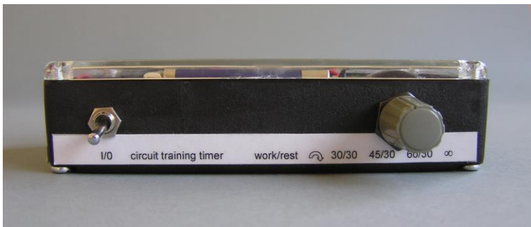
Bild 4: Ansicht der Bedienseite des Signalquellenschalters. Am Drehknopf können die work/rest Intervalle 30/30, 45/30 und 60/30 sowie Dauerbetrieb " \infty " gewählt werden
