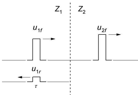
Bild 1: Rechteckpuls der zeitlichen Breite  $\tau$ , mit der Spannungsamplitude  $u_{1f}$ , der von links kommend auf eine Stoßstelle des Wellenwiderstands an der vertikalen strichlierten Linie trifft und dort auf einen durchgehenden Impuls  $u_{2f}$  und einen reflektierten Impuls der Amplitude  $u_{1r}$  aufgeteilt wird. Die Amplitudenverhältnisse sind hier für den Fall  $Z_2/Z_1=1.5$  dargestellt.
