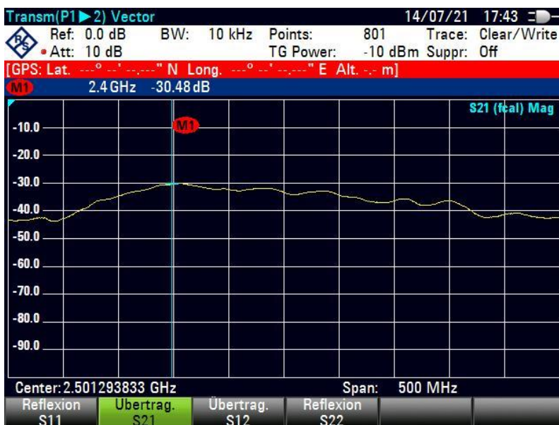
Bild 9: Vorwärtstransmissionsfaktor S_{21} im Frequenzbereich von 2.25 bis 2.75 GHz bei einer Winkelstellung der Empfangsantenne von -30^\circ
