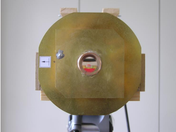
Bild 8: Blick auf die Empfangsantenne POTY 2. Durch den Hohlleiter ist die Libelle der kleinen Wasserwaage zu erkennen. Der markierte Pfeil zeigt die Drehlage der Antenne, die für die zweite Messreihe verwendet wurde (vgl. Bild 10, rautenförmige Datenpunkte) bei der die Drehlagen von Sende- und Empfangsantenne senkrecht aufeinander stehen ( \uparrow \rightarrow )
