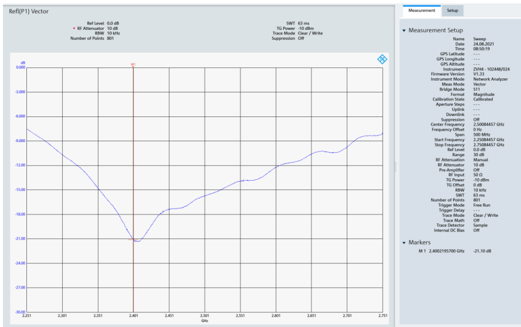
Bild 5: Rückflussdämpfung S_{11} der POTY-Antenne von Bild 1. Bei 2.4 GHz ist S_{11} = -21.1 dB
