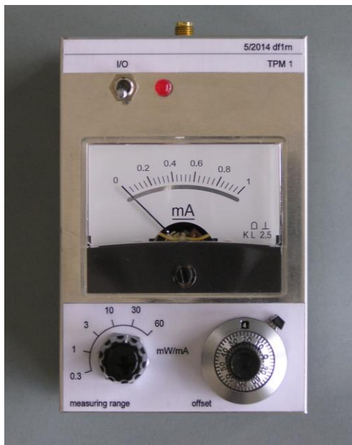
Bild 11: Frontseite des thermischen Leistungsmessers
