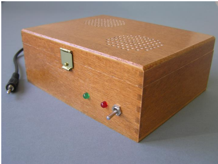
Bild 1: MP3 Stereoverstärker CDS. Links ist das Anschlusskabel mit dem 3,5 mm Stereo-Klinkenstecker zu sehen und in der Bildmitte zwei LEDs - die grüne als Aussteuerungsanzeige, die rote für den eingeschalteten Zustand - und rechts der Ein-/Ausschalter
