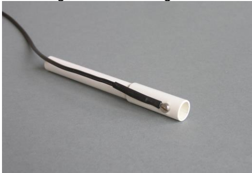
Bild 7: Oberes Ende des Antennendrahts montiert an einer Kunststoffhülse, die auf das letzte Segment des Fiberglasmastes aufgesteckt wird
