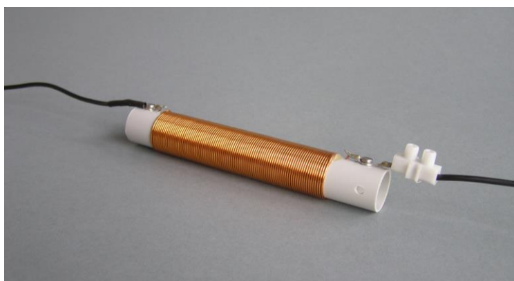
Bild 6: Spule zwischen dem unteren und dem oberen Teilstück der Vertikalantenne. Im PVC-Trägerrohr sind noch Querbohrungen angebracht, um die Spule per Kabelbinder am Mast befestigen zu können
