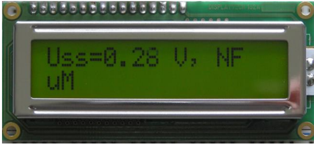
Bild 12: Anzeige auf dem LCD-Display bei einer NF-Messung
