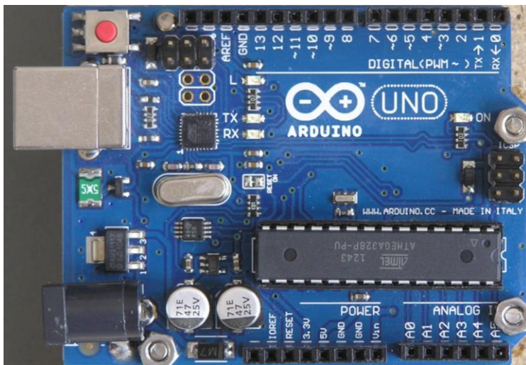
Bild 11: Das Arduino Uno Board mit dem Atmega 328P Prozessor. Links oben befindet sich ein Taster zum Reset. Die Buchse links oben dient zum Anschluss des USB-Verbindungskabels zum PC. Links unten: Buchse für die Versorgung mit Gleichspannung über ein Steckernetzteil
