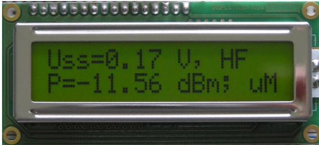
Bild 13: Anzeige auf dem LCD-Display bei einer HF-Messung. Neben der Spitze-Spitze-Spannung in der ersten Zeile wird in der zweiten Zeile die Leistung an 50 \Omega in dBm angegeben
