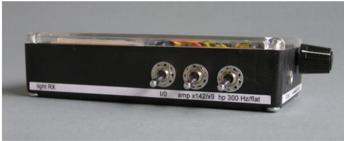
Bild 5: Die Schalter des Lichtempfängers, von links nach rechts: Ein/Aus, Verstärkung x142 oder x9, Hochpaß (hp) oder ohne Filterung (flat).
