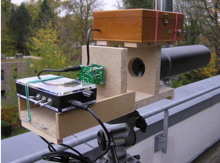
Bild 13: Der Lichtempfänger aus einer anderen Perspektive. In der Bildmitte ist die verschiebbare Halterung für den RX head mit dem Fototransistor und zwei Platinen zu sehen. Dieser wird über ein 3,5 mm Klinkenkabel an den *light RX* angeschlossen
