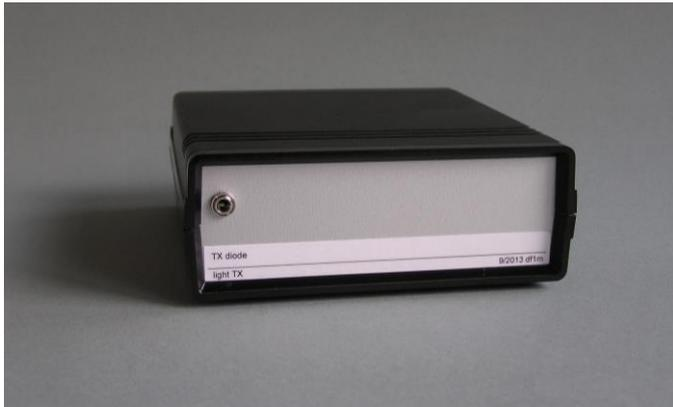
Bild 3: Ansicht der Rückseite des Lichtsenders. Links befindet sich die 3,5 mm Buchse für die Verbindungsleitung zur Sendediode
