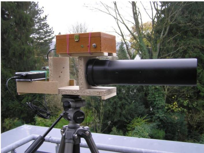
Bild 12: Der Lichtempfänger mit Empfangsoptik auf einem Stativ. Statt Kopfhörern ist ein Stereoverstärker in einer Zigarrenkiste angeschlossen
