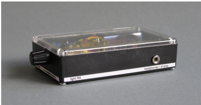
Bild 7: Auf der anderen Längsseite des Gehäuses befindet sich die 3,5 mm Buchse für den Anschluß des Kopfhörers oder eines NF-Verstärkers
