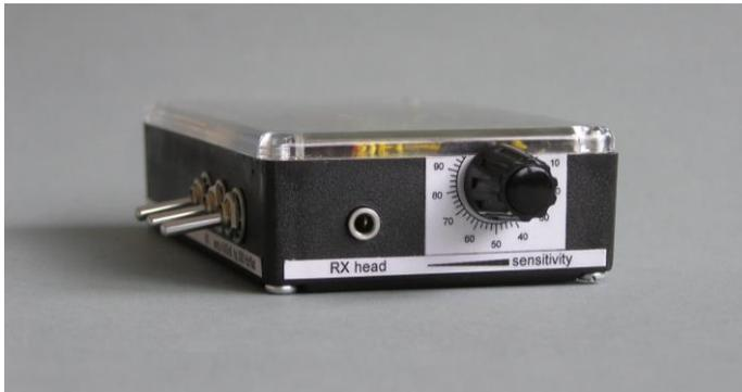
Bild 6: Anschlußbuchse für den Empfangskopf und Einstellknopf für die Empfindlichkeit.
