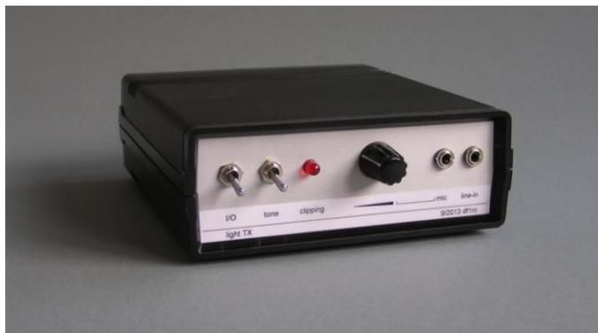
Bild 2: Der Lichtsender *light TX*. Auf der Frontseite befinden sich von links nach rechts folgende Elemente: Ein-/Ausschalter, Pilotton, Übersteuerungsanzeige, Empfindlichkeitseinstellung für den Mikrofoneingang, 3,5 mm Buchse für den Mikrofonanschluss, 3,5 mm Buchse für den Anschluß einer NF-Quelle
