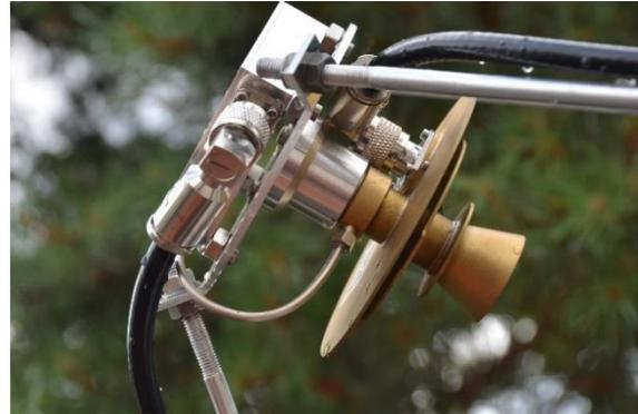
dien. Erste Hörversuche unternahm DJ8EI bereits Mitte Februar mit Inbetriebnahme des Satelliten. Dabei bestand seine Ausrüstung aus einem gebrauchten 70 cm Offset Spiegel mit einem TV LNB für 6,90 € und einem SDR-Stick für 18 €.
