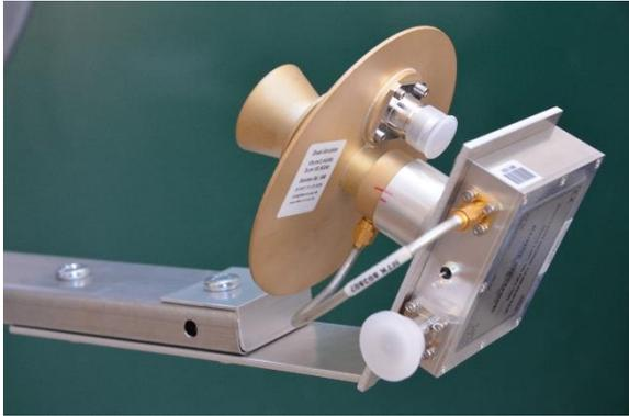
Im Fokus des Parabolspiegels befindet sich eine zirkular polarisierte Sendeantenne für die Uplink Frequenz von 2,4 GHz (das ist in der Nähe der WLAN-Frequenzen).
