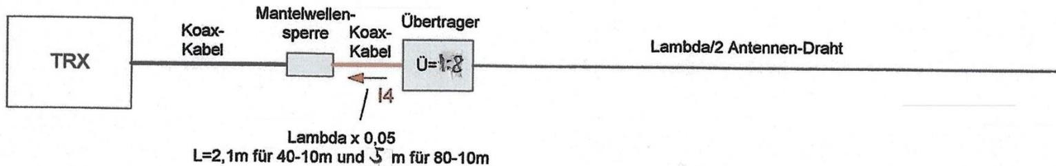
Gegengewicht durch ein Stück Koaxkabel (rot) zwischen Mantelwellensperre und Übertrager
