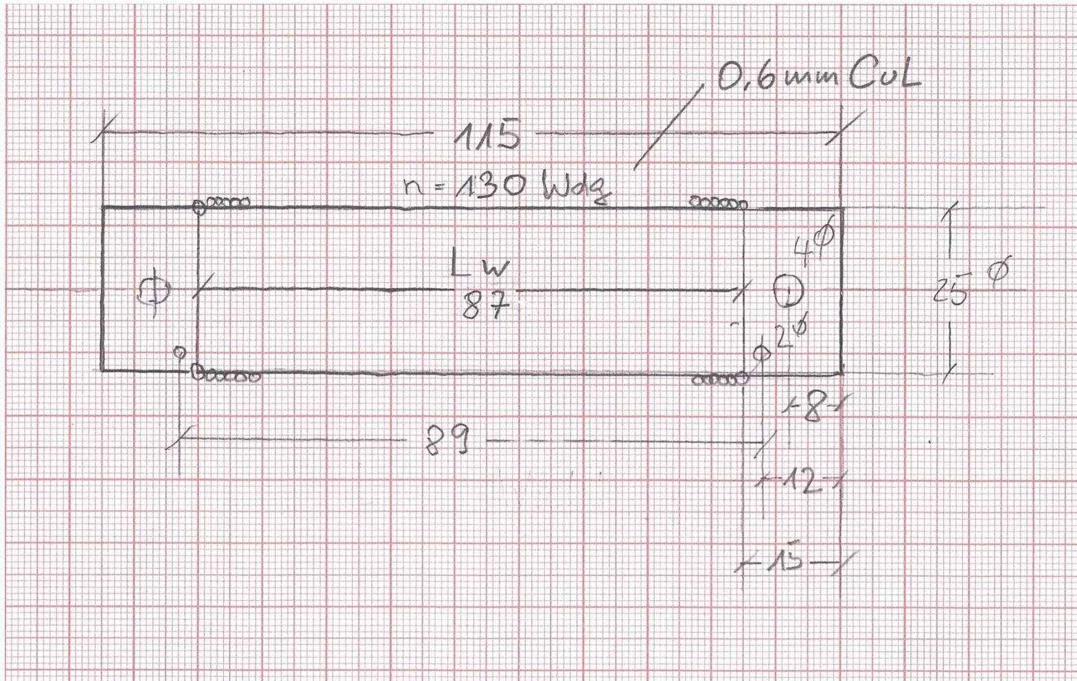
Material: GFK Rohr 25 mm Durchmesser
