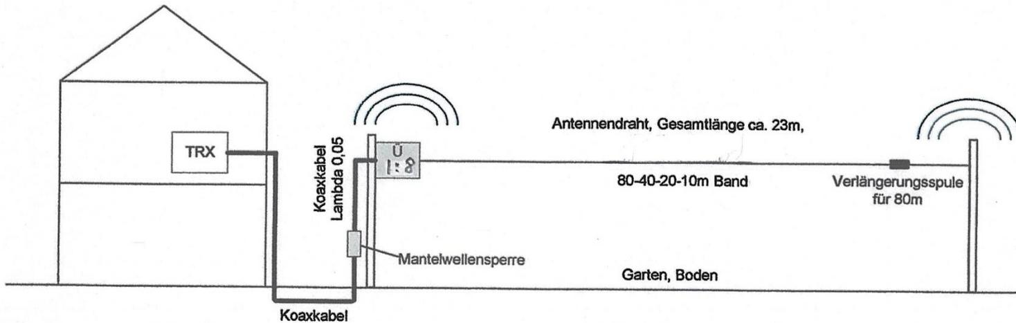
Installation einer HyEndFed-Antenne mit Strombalun im Abstand  $0,05 \lambda$  zum Übertrager
