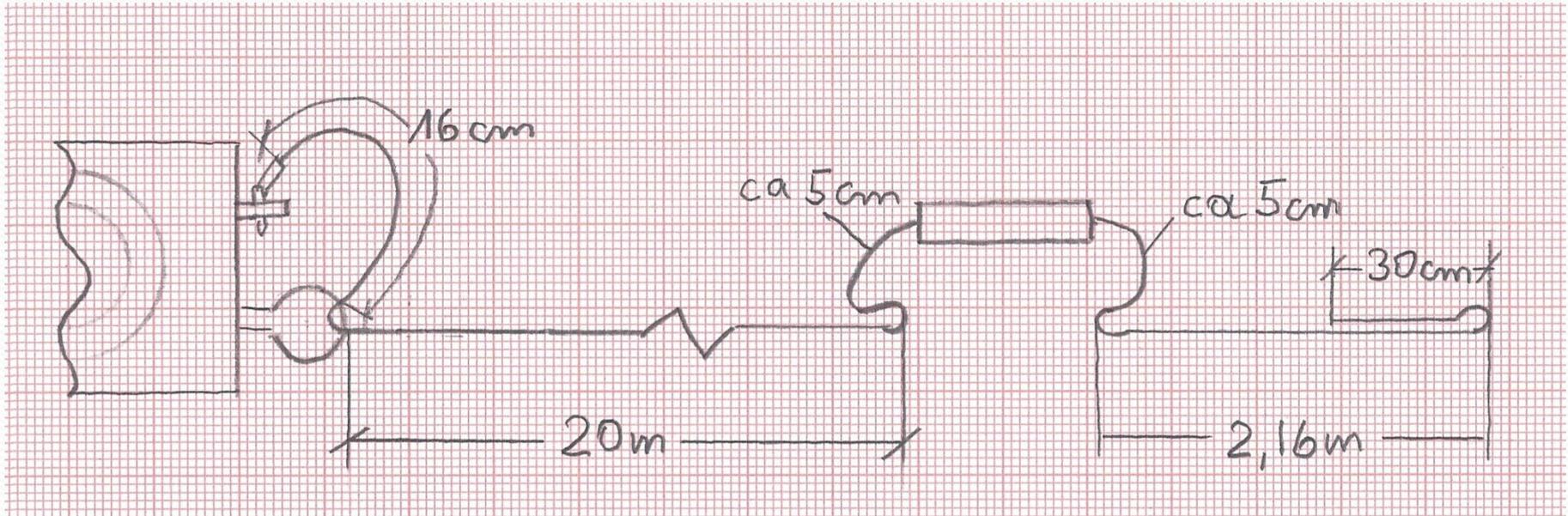
Antennendraht: DX – Wire FL, Antennenlitze aus Hartkupfer, 32 x 0,20 mm, PE Isolation, Außendurchmesser 2,0 mm
