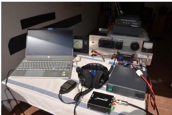
Wenige Tage nach dem erfolgreichen Test der Empfangsseite unserer QO-100-Bodenstation folgte bei Hans (DJ8EI) der erste Sendetest der neuen im Bau befindlichen QO-100 Bodenstation von G09.
