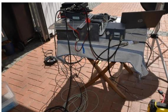
Nach zweiminütigem Ausrichten des 65 cm Offset Spiegels konnte die PSK Mittelbake mit einem über 25 dB starken Signal über dem Noise Floor stabil aufgenommen werden. Das entspricht einem Signalrapport von üblichen S9.
