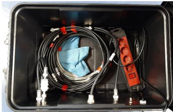
In der Box befindet sich der 144 MHz - 2,4 GHz Upconverter, ein kräftiges 12 Volt Netzteil - die PA leistet 20 Watt - die 12 Volt Einspeiseweiche ("BIAS TEE") für den 10 GHz - 433 MHz Downconverter und die Anschlüsse für die PTT sowie alle Verbindungen
